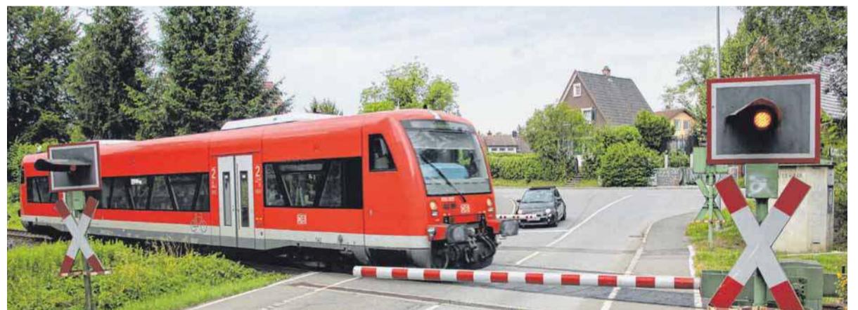
So sollte es im Normalfall sein: Die Signalanlage blinkt und klingelt, die Schranken sind unten, der Zug passiert den Bahnübergang - wie hier bei den Wangener Fachkliniken. FOTO: BEE
